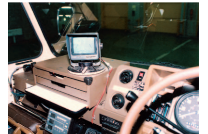
運転席から車両後方の様子を見ることができ「事故るもんカー」のバックアイカメラ
